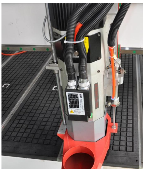
Шпиндель 9кВт (Китай)
